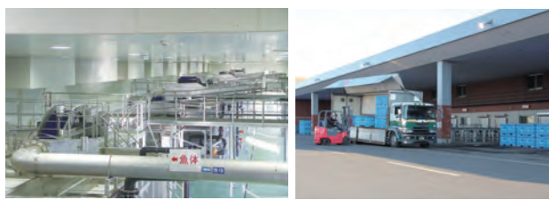
漁船の魚倉から直接フィッシュポンプで吸い上げて、魚を箱詰めします
